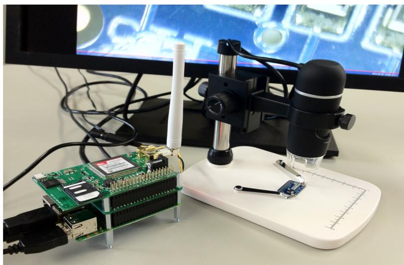
USB マイクロスコープ／カメラ等のデバイスからの映像を自動で撮影／取込み、クラウド環境へ自動アップロードを行います。
